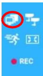
**Modo De Layout:** Permite que determinadas câmeras apareçam no monitor a partir de algum evento configurado anteriormente. O modo de layout possui dois modos de funcionamento: Pop-up e Layout Dinâmico. Para selecionar o modo de layout clicar com o botão direito em do ícone e selecionar o modo desejado.
