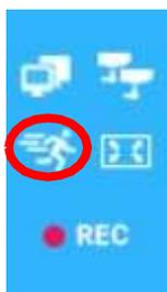
**Layout Dinâmico:** Ativando o modo Layout Dinâmico permite que o monitor receba as câmeras de acordo com o evento configurado anteriormente. Para o funcionamento deste modo deve ser feita a configuração de eventos em: Configurações > Eventos > Ações > Layout Dinâmico
